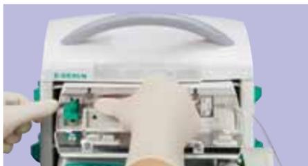
Presione la línea dentro del sensor de presión superior **6**, el sensor de presión inferior y el sensor **7** de aire **8**. Asegúrese de que la línea tiene buen contacto con la superficie de cada sensor.
