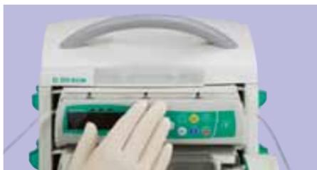
Lleve la línea a través de las guías de entrada y salida de la bomba **9**. Cierre la puerta presionando en la mitad de la bomba.
