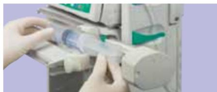
Inserte una jeringa en un ángulo de las aletas de 45° y luego diríjalas hasta el eje de fijación.
