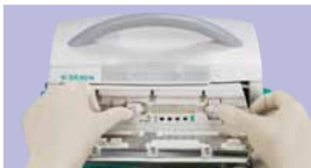
Coloque la línea directa al elemento de perfusión de la bomba **2** y asegure el clip **3**. Confirme que la silicona no está retorcida.
