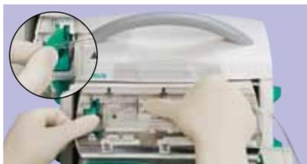
Inserte el clamp verde de protección anticaída del flujo libre del Set IV dentro de la apertura **4** y presione hasta que la palanca de apertura ajuste el clamp plateado anticaída de flujo libre **5** y éste cierre la línea (el LED de advertencia de flujo libre **11** se apaga).
