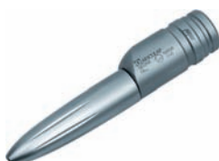
GB376R GB673R cabezal portafresas mini-Line recto; para vástagos de 2,35 mm; para fresas hasta 70 mm de longitud; boquilla rociadora GB378 (no incluida) 1:2; 108 g
