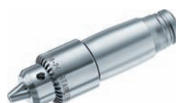
GB377R GB674R cabezal portabrocas de trabajo pesado mini-Line portaherramientas tipo Jacobs; boquilla rociadora GB378 (no incluida) Ø 0 - 6,5 mm 36:1; 2,5 mm; 220 g piezas incluidas: GA031R llave
